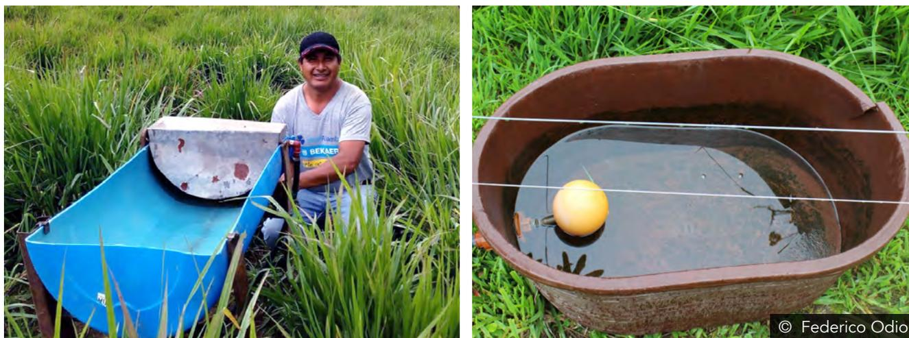
La instalación de un flotador permite el cierre automático de la válvula para evitar el desperdicio. En la fotografía a continuación se muestra este sistema (Figura 76):
