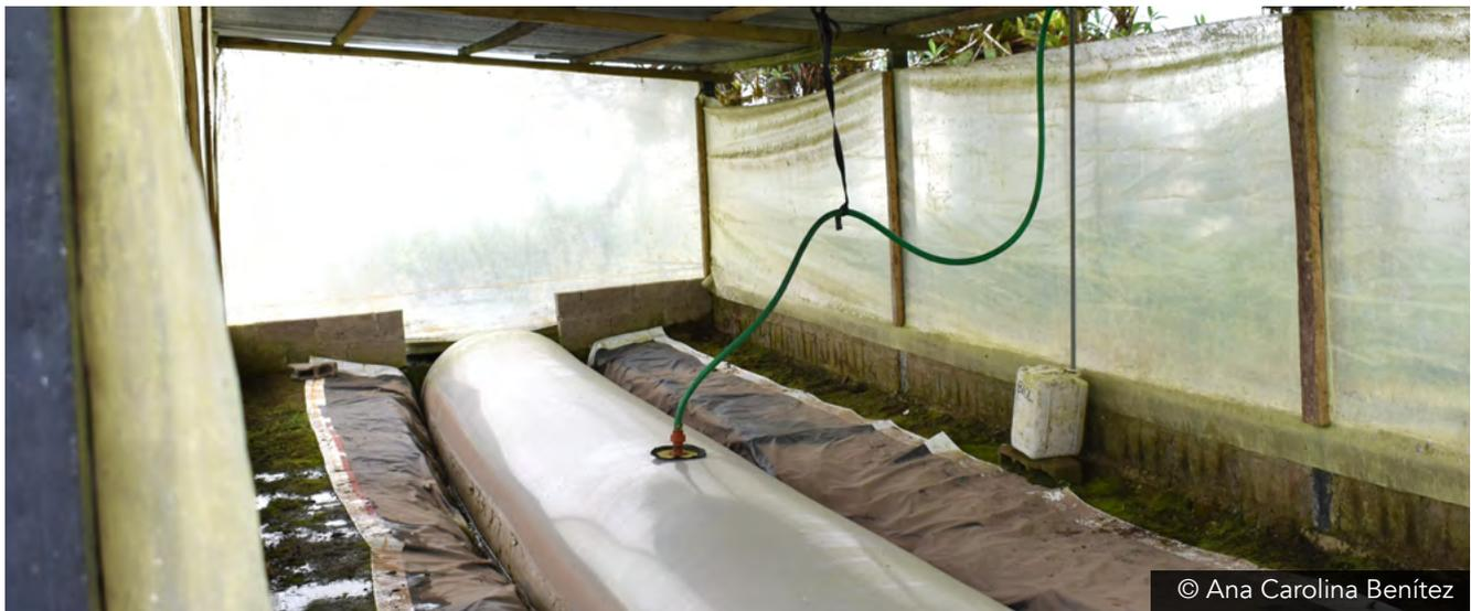
La fermentación del estiércol diluido se produce por sí sola dentro del plástico tubular (ver Figura 35), obteniéndose: biol, biosol y biogás.
